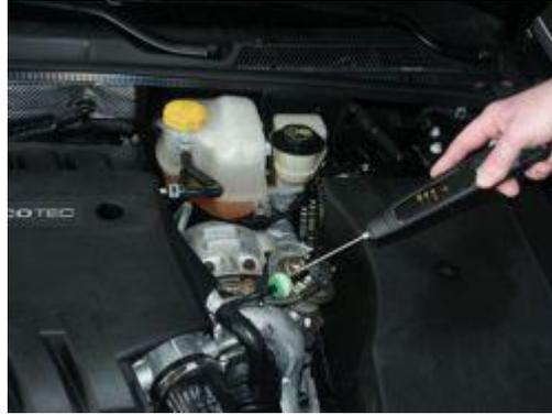
Uso del medidor de vibración electrónico PCE-S 41 comprobando un turbocompresor.
