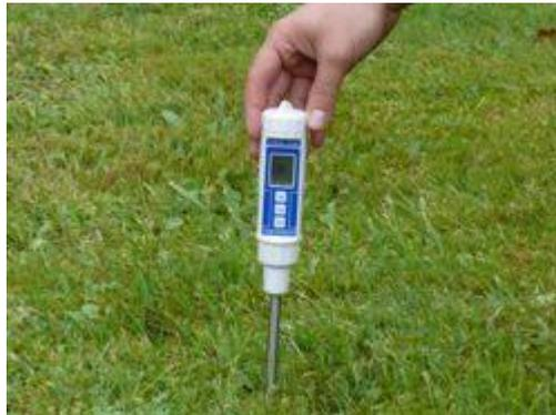
Aquí ve el medidor de humedad de tierra detectando la humedad en la tierra.
