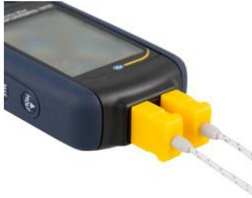
Aquí observa ambos termoelementos conectados al termómetro.
