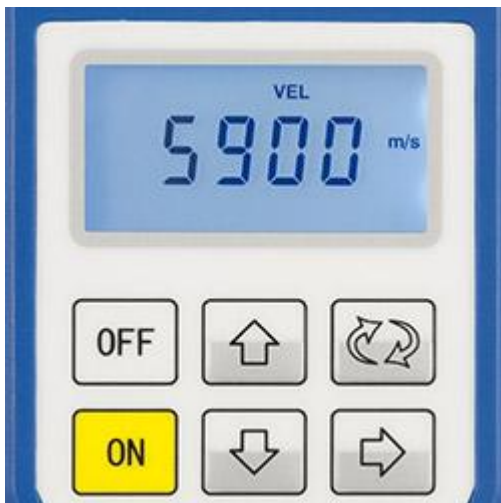
Aquí se ve el medidor de espesores ajustando la velocidad de sonido
