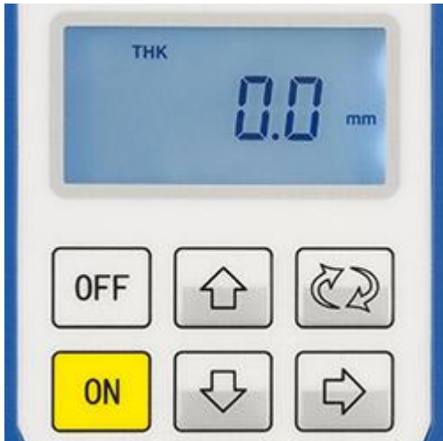
Aquí observa el medidor de espesores en el modo de medición
