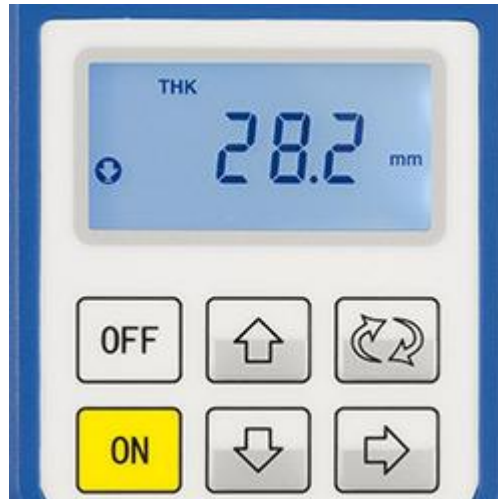
Aquí ve el medidor de espesores leyendo un valor de medición
