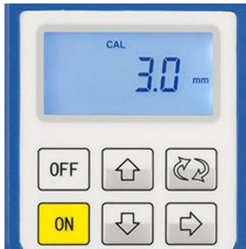
Aquí se muestra el medidor de espesores en el modo de calibración
