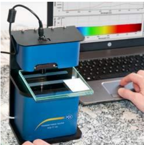
Comprobando con el medidor de transmisión luminosa un doble acristalamiento
