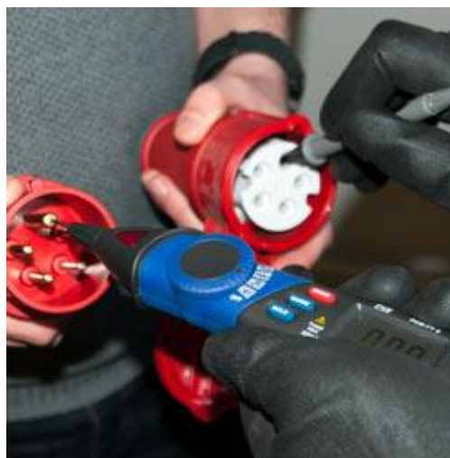
El multímetro tipo lápiz PCE-TT 3 comprobando la polaridad de un alargador
