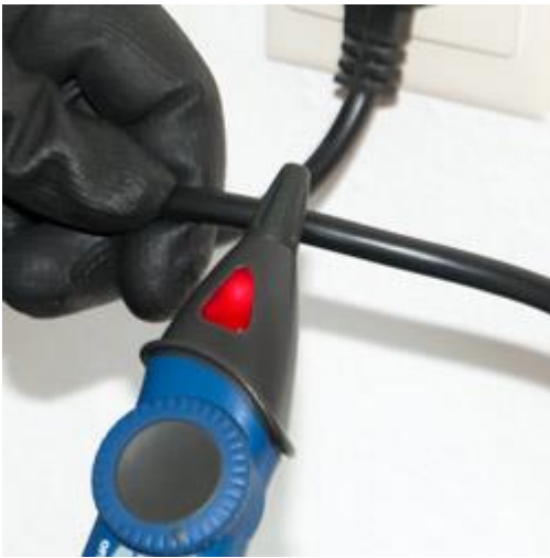
Comprobación de tensión midiendo sin contacto con el multímetro tipo lápiz PCE-TT 3
