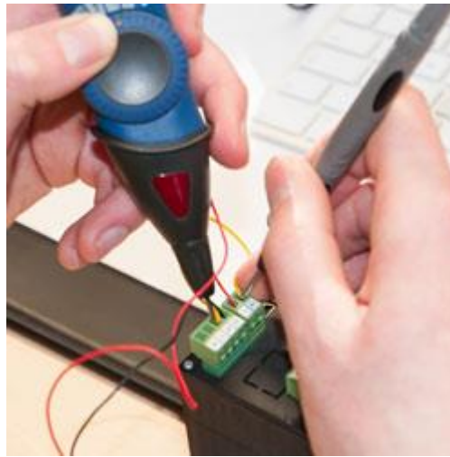
Midiendo la tensión de entrada de un regulador con el multímetro tipo lápiz PCE-TT 3
