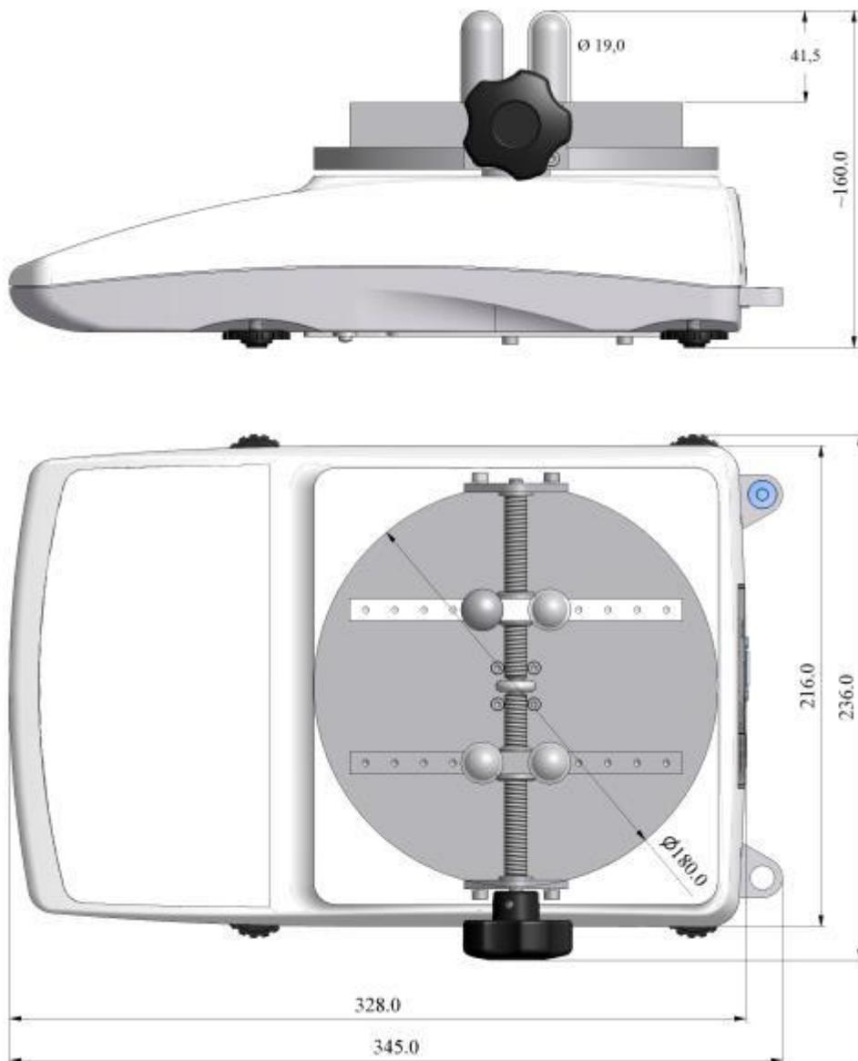
Dimensiones del torquímetro para cierres roscados de la serie PCE-TTM
