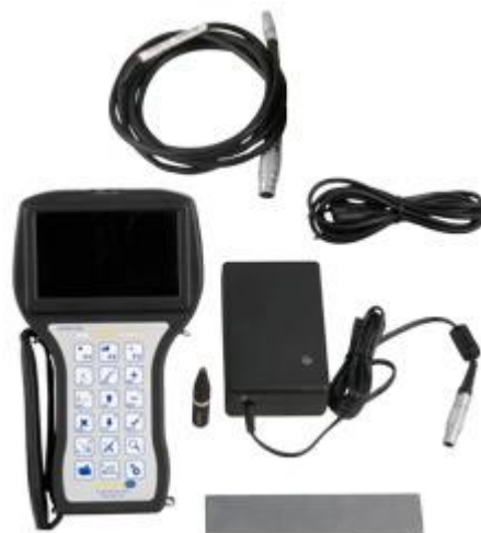
Aquí observa el cable para conectar y la sonda de medición del defectoscopio.
