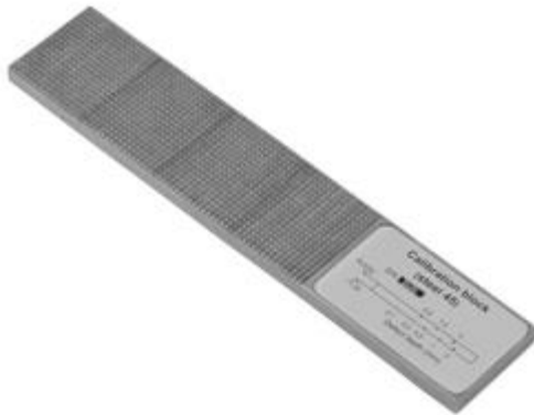
Parte frontal del estándar de calibración del defectoscopio.
