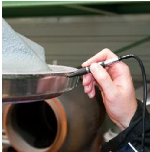
Puede situar la sonda fina del defectoscopio sobre la pieza de ensayo en diferentes ángulos.
