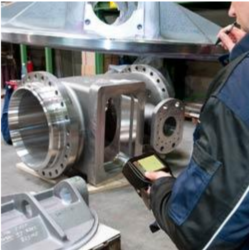
El defectoscopio es un equipo de mano, alimentado por un acumulador.
