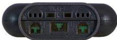
El adaptador incluido en el env\u00edo permite la conexi\u00f3n de un termoelemento. Adem\u00e1s puede conectar aqu\u00ed directamente resistencias y condensadores a trav\u00e9s del conector o las patas para componente SMD.
