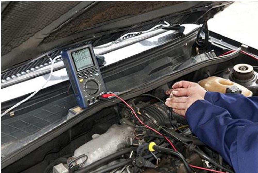
A la derecha observa el osciloscopio de mano en proceso. Las múltiples funciones reunidas en una carcasa compacta y ligera, y la alimentación por batería son condiciones óptimas para usar este aparato de forma móvil. En caso que piense transferir datos a un PC durante un período prolongado tiene la posibilidad de alimentarlo a través del componente de red que se incluye en el envío. Por tanto, es también muy apto para usarlo en el taller.
