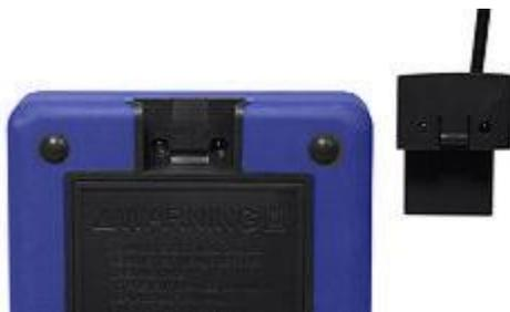
El puerto asilado ópticamente se sitúa posterior de la carcasa.
