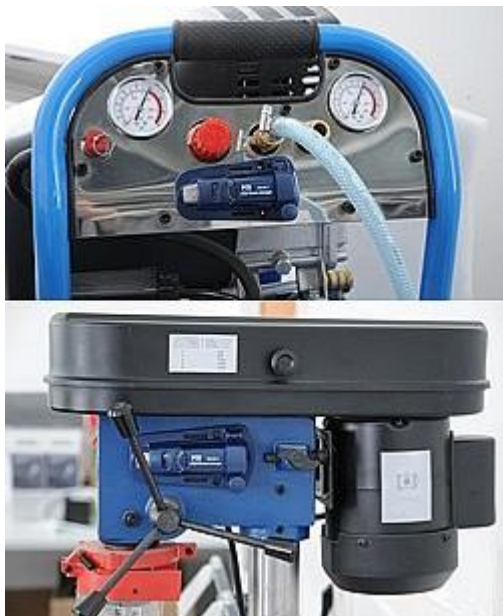
Aquí ve el registrador de vibración en varias máquinas para el control y análisis de la maquinaria
