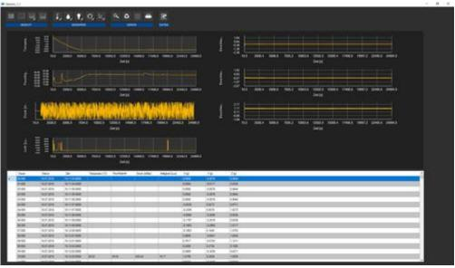
El software incluido en el envío le permite leer y analizar los valores de múltiples registradores de datos. Para que la fecha y hora de todos los registradores de datos sean idénticos, hemos equipado el PCE-VDL 16l con un reloj en tiempo real (RTC).
