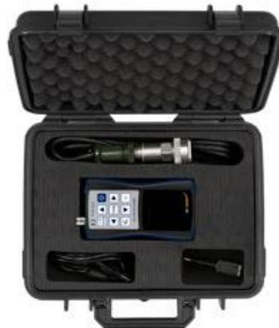
Las conexiones de los sensores del vibrómetro PCE-VM 20 están situados en la parte inferior
