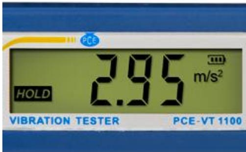
La pantalla del vibrómetro mostrará el resultado de la última medición hasta que se apague automáticamente
