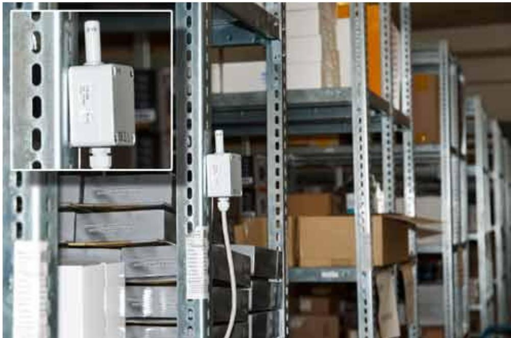
El sensor del sistema de supervisión de almacenes puede ser montado de forma discreta en cualquier punto del almacén. La conexión se realiza a través de la clavija de cable RJ45 El sensor se puede conectar además con la unidad principal mediante cualquier cable de red.
