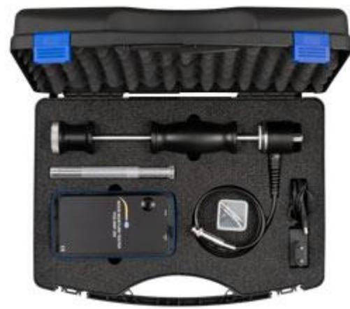
**Contenido de envío del medidor de humedad Bluetooth PCE-WMT 200**
