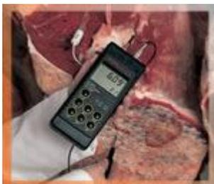
El pH-metro HI 9124 efectuando una medición de pH y temperatura en la carne.
