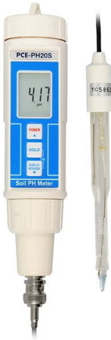
Así, el pH-Metro para el suelo es la solución ideal para una medición del valor pH en tierra, substratos y soluciones de riego en jardinería que se usan en invernaderos o en productos y empresas agrícolas.
