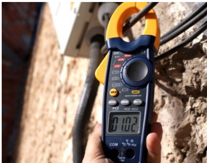
Amperímetro PCE-DC4 midiendo la corriente consumida en una cometa.
