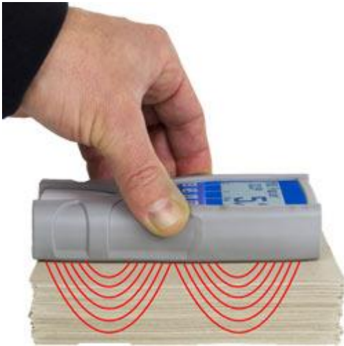
Visualización gráfica del principio de medición del medidor de humedad de papel.
