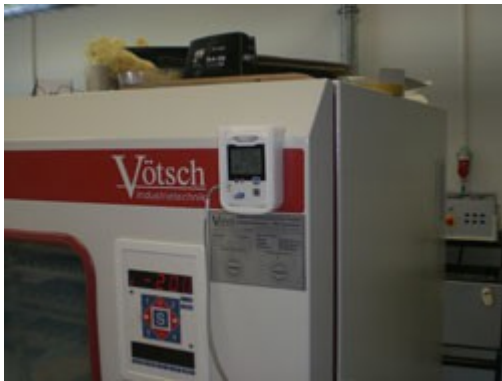
Control de temperatura en incubadoras (con sensor externo)
