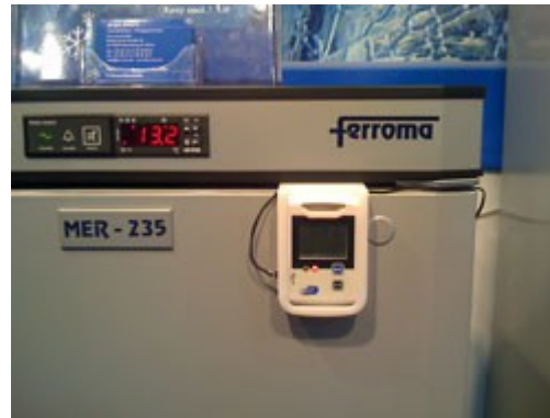
Supervisión de frigorífico también con sensor de temperatura externo
