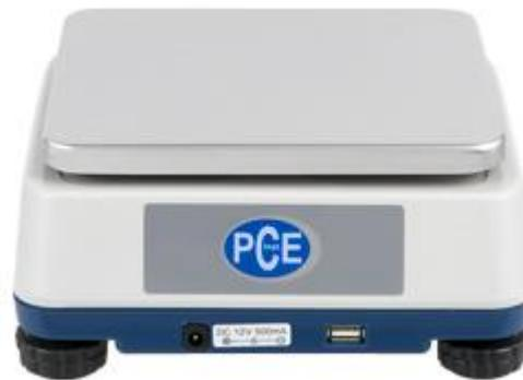
En la parte posterior de la balanza compacta se aprecia la interfaz USB y la conexión para el componente de red, incluido en el envío.
