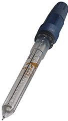
Electrodo Redox para regulador de Redox fijo Smart LC-pH
