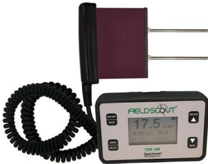
Medidor de humedad de tierra TDR-150
