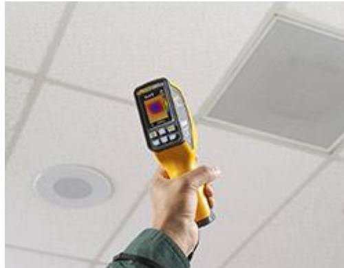
Se está realizando una medición en una instalación de ventilación con la cámara termográfica.
