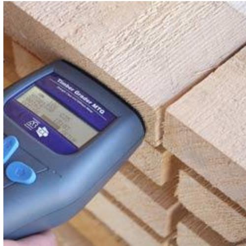
El medidor de resistencia de madera es muy fácil de usar. Muestra los datos de medición de maderas de coníferas o frondosas en un tiempo muy reducido.
