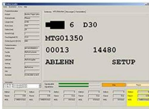
Gracias al Software incluido, podrá aprovechar al máximo el medidor de resistencia de madera para clasificar la madera automáticamente y, por lo tanto, crear un cuaderno de control.
