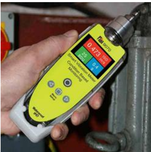
Medición con el medidor de vibraciones TPI 9070
