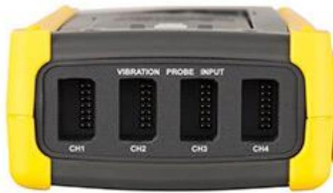
Aquí ve los puntos de conexión del vibrómetro de 4 canales.
