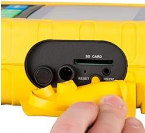
Las conexiones del vibrómetro de 4 canales PCE-VM 5000.
