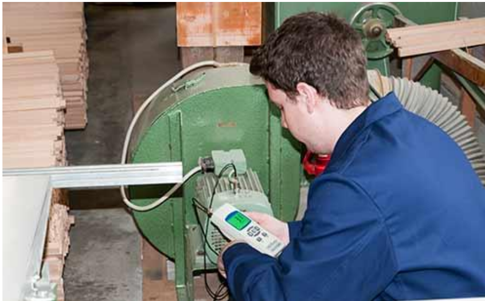
Vibrómetro PCE-VT 2800 durante la comprobación de un motor
