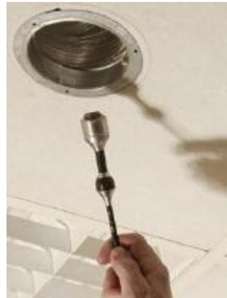
Con el endoscopio podrá analizar los daños en canales de ventilación y localizarlos con la ayuda del cable deslizante.
