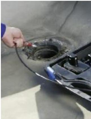
Aquí puede ver el endoscopio analizando conducciones de agua y de aguas residuales en el sector industrial.
