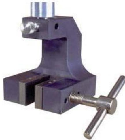
Mordazas para el cabezal de sujeción atornillable TH56g
