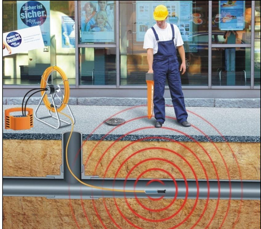
Como alternativa, se pueden localizar también con el receptor sondas activas (por ej., cámaras de sondeo) de una frecuencia adecuada (vea en Datos Técnicos). Para disponer de información detallada sobre la forma de proceder, deberán consultarse siempre las instrucciones de uso del producto utilizado.
