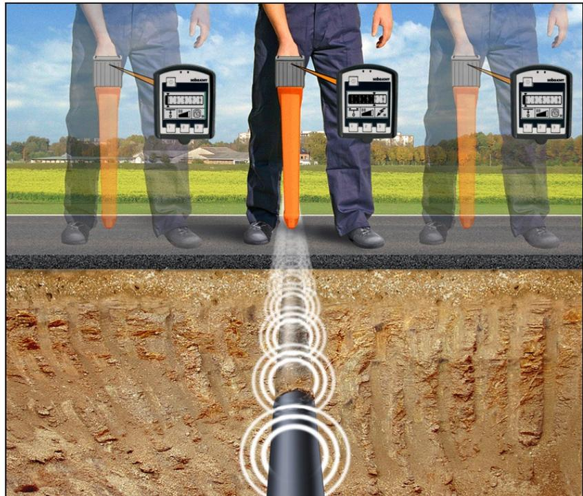
La alineación del receptor respecto al trayecto del conducto, como resultado de la colocación de las antenas, tiene el siguiente efecto en la potencia de la señal de recepción:
