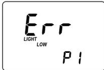
**Light Low:** No hay suficiente luz para realizar una medición. Compruebe la preparación de la cubeta del cero.
