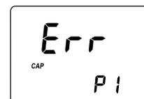
**Cap error:** Aparece cuando entra luz externa en la célula de medición. Asegúrese de que la cubeta esté tapada.
