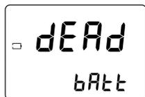
**Dead battery:** Esto indica que la pila está agotada y debe ser sustituida. Tras mostrar esta indicación, el instrumento se desconectará. Cambie la pila y reinicie el medidor.
