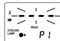
**Cooling lamp:** El instrumento espera a que la lámpara se enfríe.
