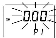
**Under range:** Un mensaje "0.00" intermitente indica que la muestra absorbe menos luz que la referencia cero. Compruebe el procedimiento y asegúrese de que usa la misma cubeta para referencia (cero) y medición.
