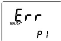
**No Light:** El instrumento no puede ajustar el nivel de luz. Compruebe que las muestras no contengan detritos.
