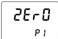
**Zero:** No se ha tomado una lectura cero. Siga las instrucciones del procedimiento de medición para poner a cero el medidor.
