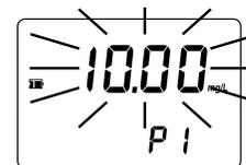
**Over Range:** Un valor intermitente de la máxima concentración indica una condición por encima de rango. La concentración de la muestra está por encima del rango programado: diluya la muestra y vuelva a realizar el test.
