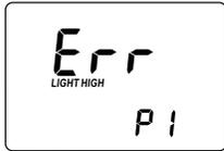
**Light High:** Hay demasiada luz para realizar una medición. Compruebe la preparación de la cubeta del cero.
