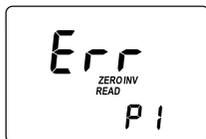
**Inverted cuvetts:** La cubeta de la muestra y la del cero están invertidas.
