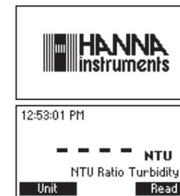
El instrumento carga el idioma seleccionado. Si no se puede cargar el idioma, el instrumento funcionará en "safe mode" (MODO SEGURO). En "safe mode" todos los mensajes se muestran en Inglés y no se dispone de información relativa a Tutoría y Ayuda.
