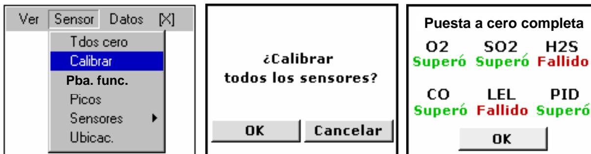
Después se muestra la pantalla que alerta al usuario de que conecte gas al instrumento. Cuando el sensor inicia la lectura de gas, empieza la calibración. El usuario tiene 5 minutos para aplicar gas antes de superar el tiempo de espera de la calibración. El gas se debe aplicar con un caudal de 0.5 lpm. Si el usuario decide omitir un sensor, el instrumento pasará al siguiente sensor. La opción Abortar cancela la calibración y muestra las pantallas Calibración completa.
