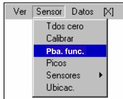
Después se muestra la pantalla que alerta al usuario que aplique gas al instrumento. El usuario tiene un número determinado de segundos para aplicar el gas y seleccionar Comenzar antes de que transcurra el tiempo de espera de la prueba funcional. Si el usuario selecciona Omitir, no se inicia la prueba funcionar para ese sensor concreto. El instrumento pasa al siguiente sensor en la lista.
