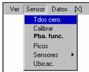
Si hay un sensor de CO<sub>2</sub> en el instrumento, se pone a cero en último lugar. Se debe aplicar aire cero para poner a cero un sensor de CO<sub>2</sub>. El instrumento solicita al usuario que aplique aire cero. El botón OK está marcado. Si el usuario lo selecciona, se inicia el proceso de puesta a cero del sensor de CO<sub>2</sub>.
