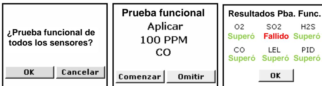
Si más de un sensor falló la prueba funcional, se calibran en orden (fila superior de izquierda a derecha, fila inferior de izquierda a derecha en la pantalla de lecturas normales), de uno en uno y cada vez se pregunta al usuario si desea o no calibrar el sensor.
