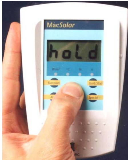
Fig. 5: Medición de los valores actuales con el Mac Solar
