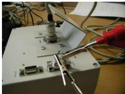
Ejemplo de prueba de la interfaz 4 -20mA con la resistencia R_{we} < 510\Omega
