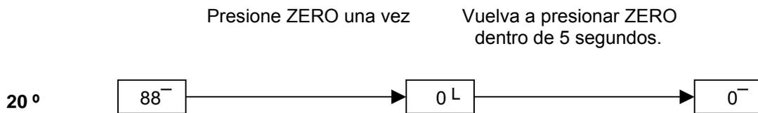
Si no se presiona la tecla ZERO dentro de los 5 segundos, la pantalla vuelve al modo de medición.
