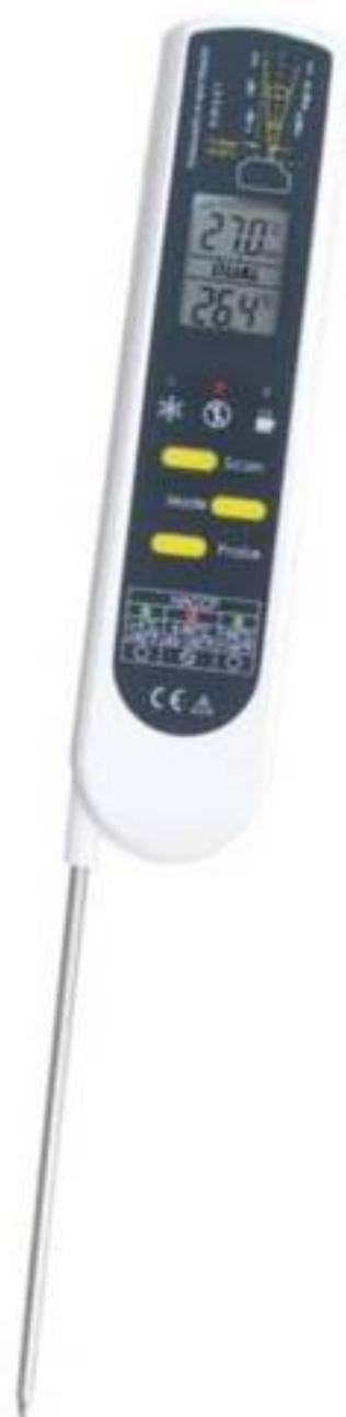
El PCE-IR 100 es a la vez un termómetro infrarrojo (medición sin contacto) y un termómetro de contacto con sonda de penetración. Apoyar la tecla Scan para medir la temperatura sin contacto. Apoyar la tecla Meas para medir la temperatura con la sonda de penetración.
