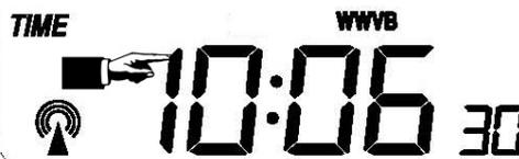
1) toque sobre la sección donde marca la hora (TIME). Los botones + y – comenzarán a parpadear. Toque sobre el botón + o el botón – para ajustar el nivel de contraste deseado en pantalla de 0 a 8 (por defecto nivel 5).
