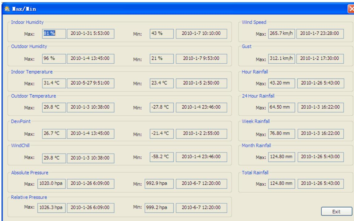
Esta configuración se usa para definir los valores MIN / MAX con fecha y hora. Sólo es posible resetear los valores MIN / MAX en la estación base.
