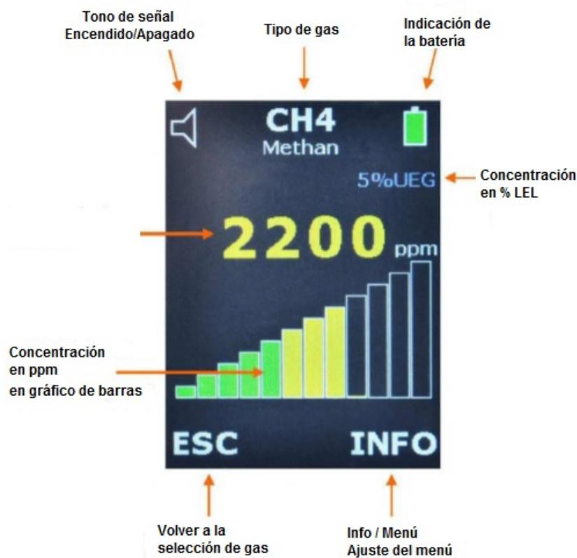
La batería restante o la capacidad de la batería se muestran con un símbolo verde cuando está por encima del 50%, en amarillo entre el 50% y el 30% y con un símbolo de batería parpadeante en rojo cuando está por debajo del 30%. Cuando no hay suficiente energía, aparece una pequeña notificación y el aparato se apaga.
