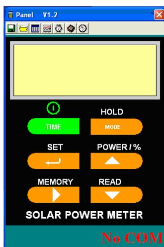
Para conectar el equipo al software debe de tener pulsado durante 6 segundos la tecla READ, y se podrá observar:
