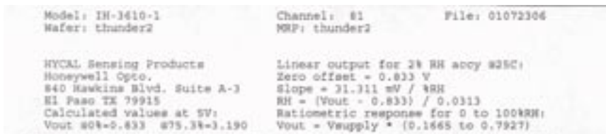
Imagen 7: Protocolo de calibración del sensor de humedad
