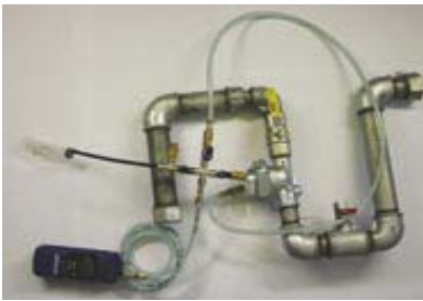
Imagen9: Imagen de la conexión para el análisis del volumen V_{\text{Probe}} de la tubería a la izquierda con una jeringuilla médica de 100 ml, a la derecha con una bomba.
