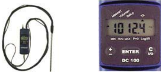
Imagen 10: Medición de la temperatura del gas de escape: Temperatura del cursor T_A
