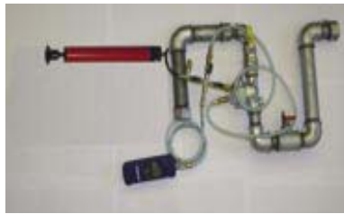
Imagen9: Imagen de la conexión para el análisis del volumen V_{\text{Probe}} de la tubería a la izquierda con una jeringuilla médica de 100 ml, a la derecha con una bomba.
