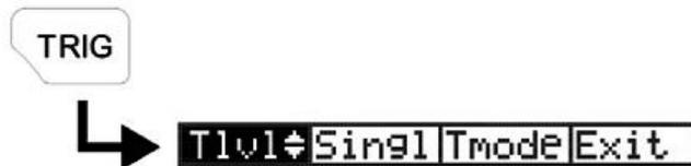
Menú del Trigger, para la configuración de este.
