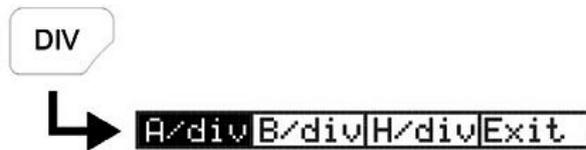
Menú para el ajuste del tiempo por división del Canal A, pulsando Botones Centrales (Arriba – Abajo) – Se selecciona el modo automático, pulsando la tecla de la derecha de los botones centrales.
