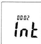
Pulse y mantenga pulsada la tecla de retroiluminación mientras enciende el aparato hasta que la pantalla le indique el símbolo "INT". A continuación, podrá ajustar con la tecla LEVEL la cuota de registro (en segundos) con el que el dispositivo almacenará los valores en la memoria.
