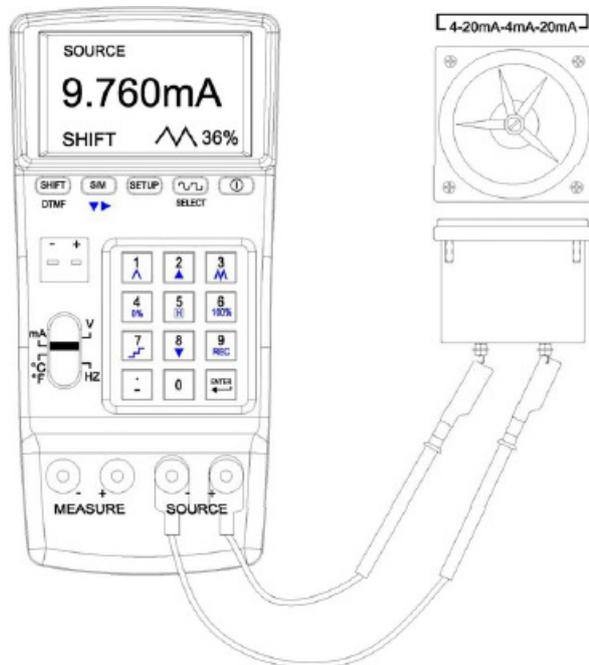
Conexión de los cables para la rampa rápida
