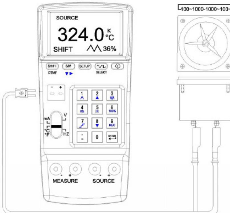
**Conexión de cables para la Rampa rápida**
