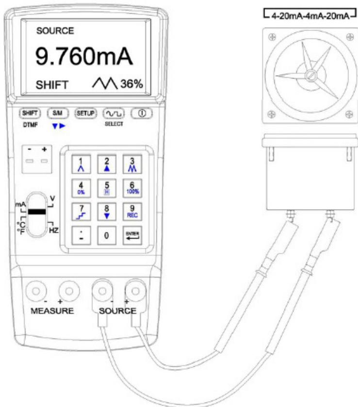
Cables de conexión para rampa rápida
