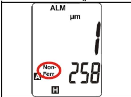
**Paso 6:** Presione la tecla "Zero" para realizar la puesta a cero y la pantalla mostrará "0".
