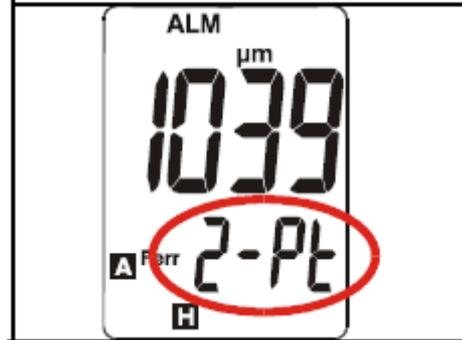
**Paso 11.** presione Zero (▼) o MAX/MIN (▲) para ajustar los valores de la pantalla a 1006 μm. Vea el **paso 12**.
