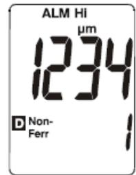
2. Use ▲ o ▼ para ver los datos anteriores o posteriores. Después, presione "CAL" para salir del modo de registro de datos y volver al modo normal.
