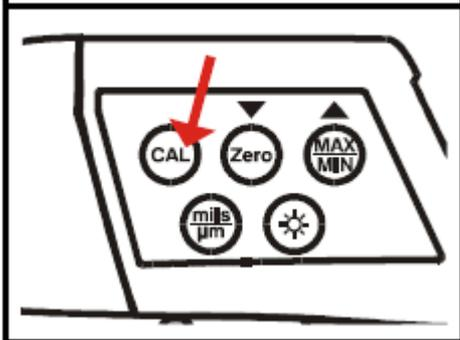
**Paso 14:** El mensaje 2-Pt desaparecerá lo que significa que la calibración se ha completado y se puede empezar con la medición.
