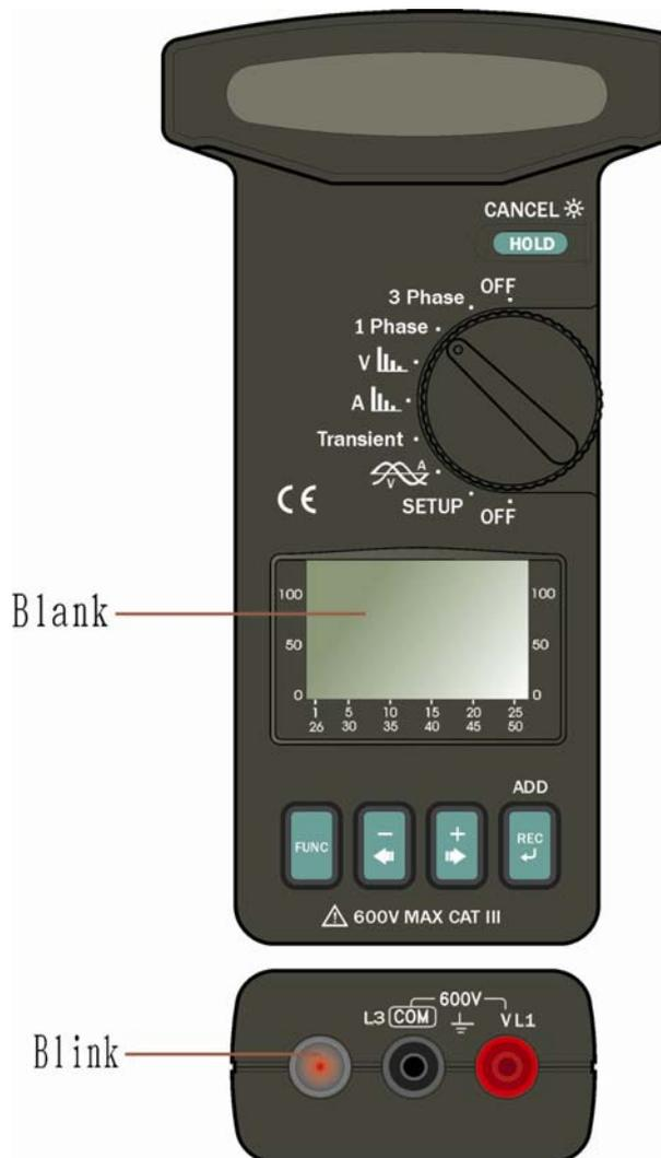
La unidad registrará 50,000 datos de (Fecha/Hora, VA, W, VAR, PF, KVAH, KWH, KVARH, PFH, AD(VA), AD(W), MD(VA), MD(W), Fase, HP).
