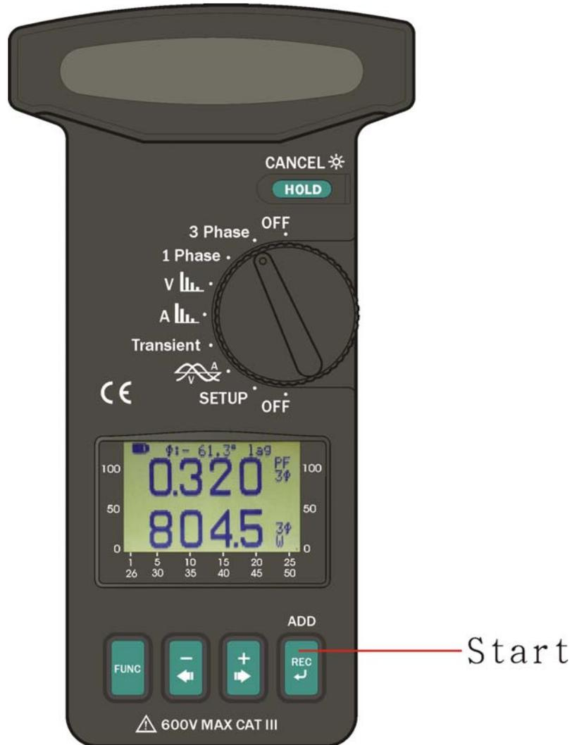
Los usuarios pueden presionar el botón REC una vez para iniciar el registro de datos programado. El **TIEMPO DE INICIO** y el **TIEMPO DE FINALIZACIÓN** se ajustan en el menú de configuración. Cuando se presiona el botón REC, los usuarios podrán ver la siguiente pantalla.
