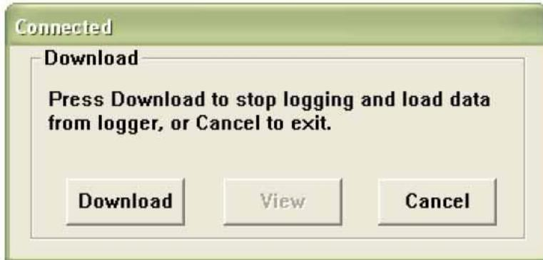
Si la transmisión se efectuó con éxito, entonces se le mostrarán las siguientes dos ventanas. En la ventana "Save" puede cambiar el nombre del fichero y guardarlo en el directorio que desee. Posteriormente puede salvar los datos en el formato que desee mediante la función "Save as" (Excel, Texto, Bitmap). Se considera con más detalle en el siguiente capítulo. Por defecto se guardan los datos como .rec y sólo pueden ser usados por este programa.
