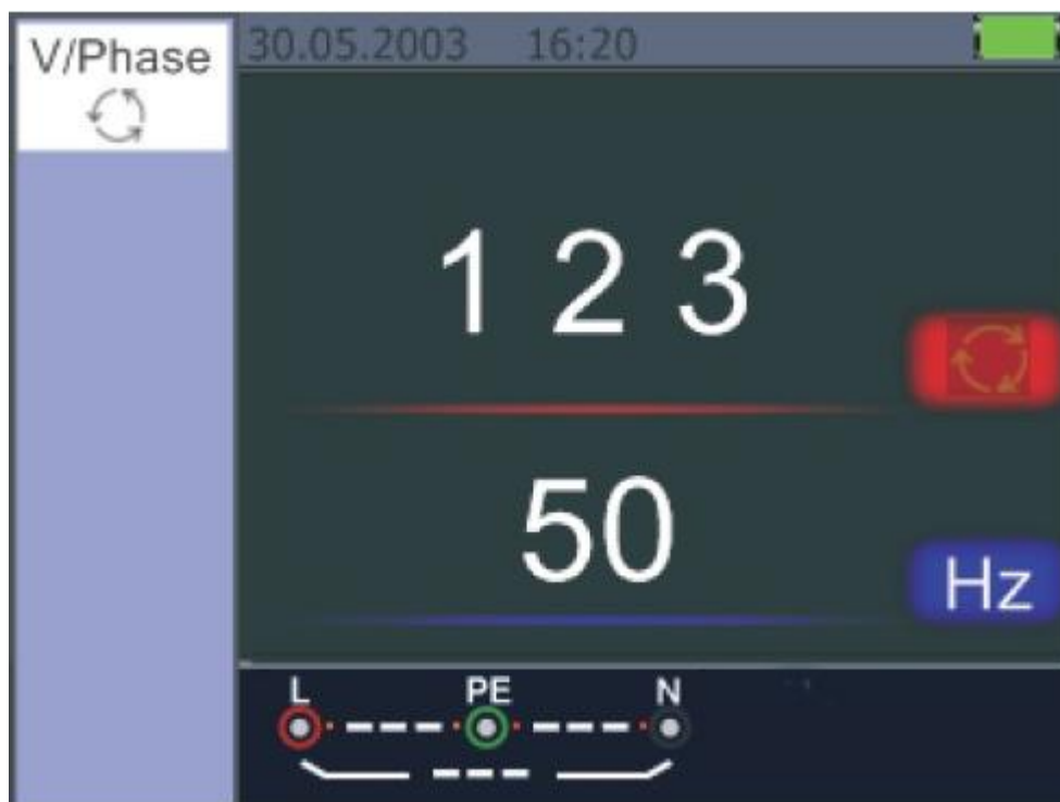
Img. 5.2.8.3 Pantalla de secuencia de fase – cuando están conectados en dirección de las agujas del reloj
