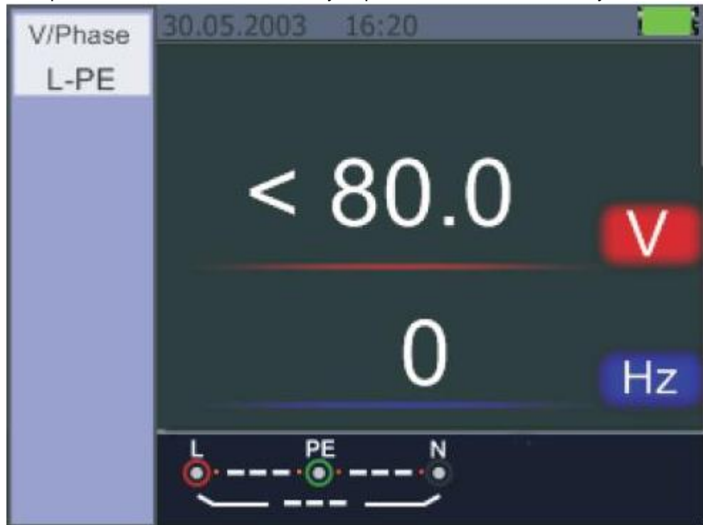
Img. 5.2.7.1 Pantalla Standby para la tensión y frecuencia
