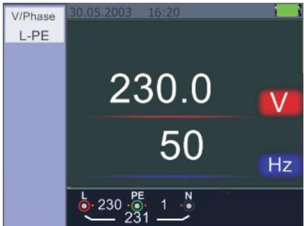
Img. 5.2.7.2 Pantalla durante la medición de tensión y frecuencia
