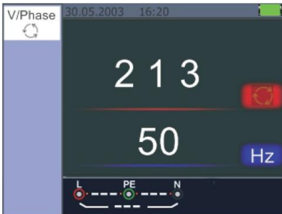
Img. 5.2.8.4 Secuencia de fase cuando están conectados en dirección contraria a las agujas del reloj
